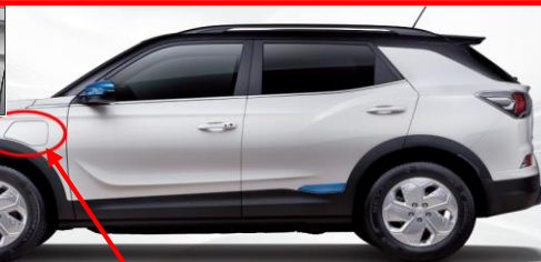
Ladetür für Elektrofahrzeuge
