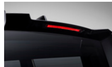
Dritte Bremsleuchte im Dachspoiler
