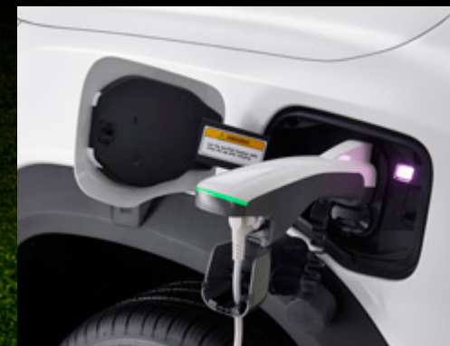
V2L Connector (als Zubehör erhältlich) Versorgt verschiedenste elektronische Geräte und Werkzeuge zuverlässig mit Strom – ideal für Outdoor-Abenteuer und Freizeitaktivitäten mit zusätzlichem Komfort.
