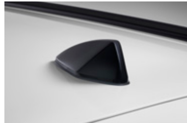
Haifischflossenantenne für Navigation und DAB+
