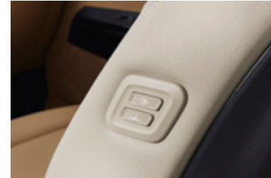
Beifahrersitzverstellung vom Fahrersitz aus
