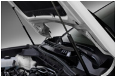
Motorhaubenstützen mit Gasdruckfeder
