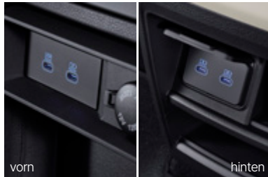
12-V-Anschluss und USB-C-Anschlüsse mit 27 W Ausgangsleistung vorn und hinten
